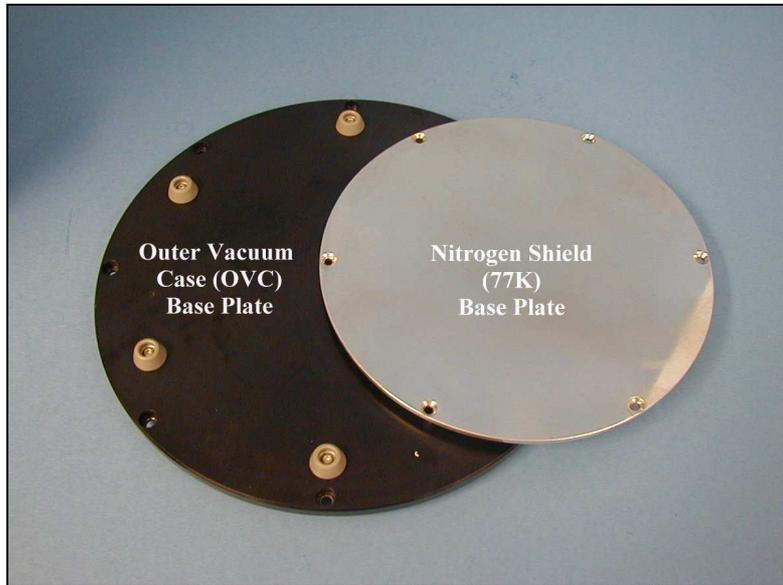
**Photo 1.3.** Cryostat base-plates
