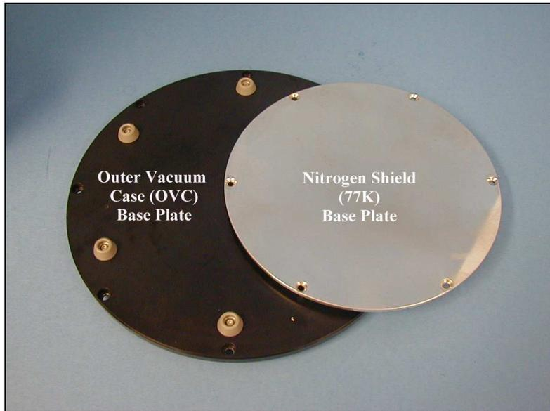
**Photo 1.3.** Cryostat base-plates
